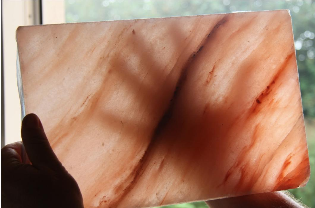
Insgesamt 38 Tonnen Salz wurden für die Innenauskleidung der Salztürme aus Pakistan eingeschifft. Im Erdgeschoss und im ersten Obergeschoss kam es im Sockelbereich als Bruchsteinmauerwerk zum Einsatz, an den Wänden als Platten.
