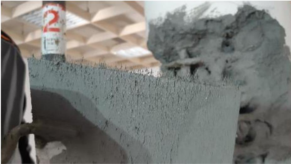
*Durch seine Faserverstärkung bietet PCI Nanocret R4 Rapid nachhaltig Stabilität. Der Reparaturmörtel ist bereits nach zwei Stunden überarbeitbar.*
