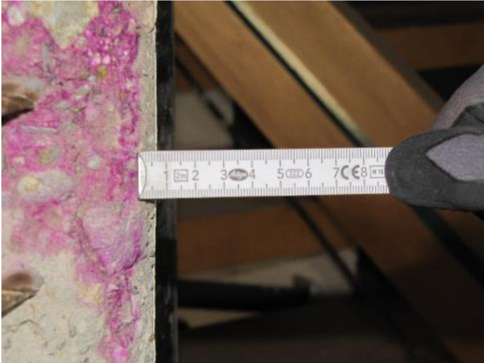
Die Verarbeiter maßen die Karbonatisierungstiefe am Beton und prüften den freigelegten Stahl bezüglich des erforderlichen Reinigungsgrades.
